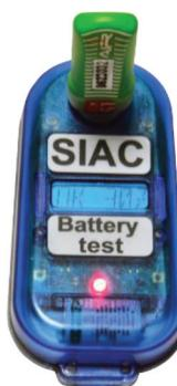
La funzionalità AIR+ della SIAC non è sempre attiva, in modo da ridurre il consumo di batteria. La funzionalità viene attivata con il punzonamento della stazione CHECK dopo la pulizia del chip, e viene spenta con la punzonatura del FINISH.
