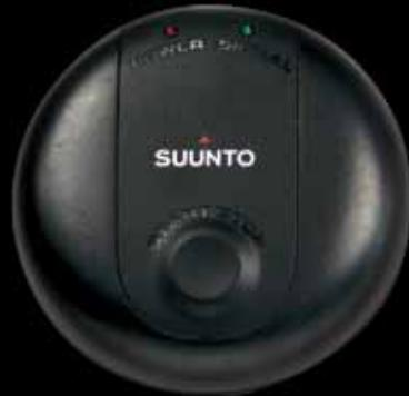
**GPS POD** Dispositivo che abbinato al Suunto t6c utilizza il Sistema di Posizionamento Globale per rilevare la velocità e la distanza mentre ci si allena.
